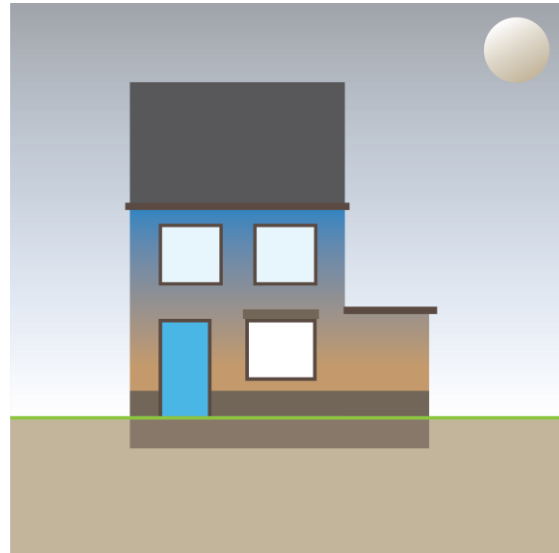
2 Hij volgt de dagelijkse temperatuurswisselingen en het jaarlijkse temperatuursverloop. Dit wordt 'thermische belasting' genoemd. Als een gevel warmer wordt dan zet hij uit en wordt langer, als hij afkoelt wordt hij korter.
