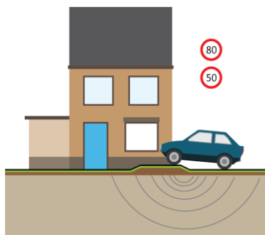
Afbeelding 3.16 Invloed van verkeerstillingen op een gebouw
