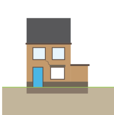
Afbeelding 3.19 Schadebeeld ontbreken dilataties in een metselwerk buitenwand
