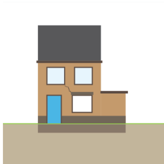
4 De fundering verhindert het verkorten van gevel die hier direct op is geplaatst. Hierdoor ontstaan er horizontale spanningen en eventueel scheuren in het metselwerk. Op de eerste verdieping is de kans op dergelijke scheuren kleiner omdat de gevel hier minder wordt gehinderd bij het vervormen.
