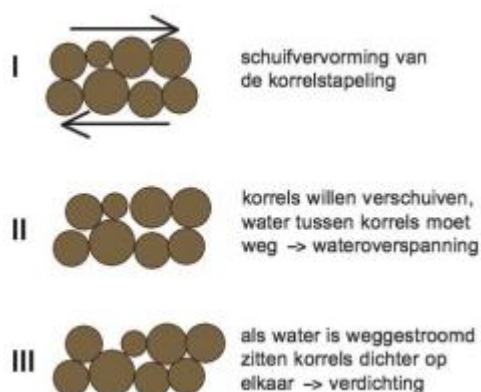
Afbeelding 2.7 Gedrag zandkorrels bij wisselende belasting [ref. 1] door bijvoorbeeld een grondwaterstandsverhoging of een aardbeving
